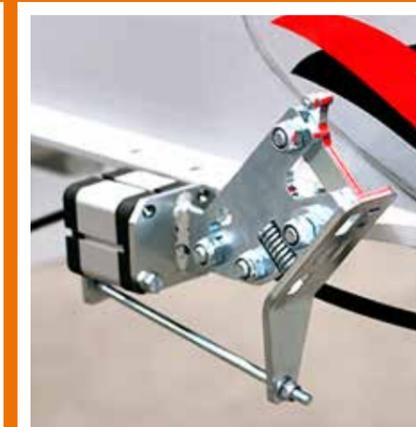
L'avantage du déclencheur pneumatique est que le conducteur n'a pas besoin de faire le tour ou même de descendre du véhicule pour défaire les arrimages l'un après l'autre. Un seul geste suffit pour désarrimer l'ensemble et cela sans quitter la cabine. Le désarrimage terminé, la sangle s'enroule automatiquement. Simple et pratique. Pour désarrimer à un seul endroit, on peut toujours utiliser le déclencheur à câble.
