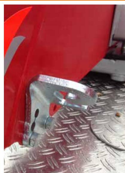
Les crochets et les anneaux sont fabriqués en acier haute résistance. Ils sont fixés par deux boulons dans les trous préformés des berces.
